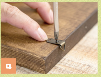
4 額縁吊り金具を取り付けます。ネジの大きさに合わせたドライバーを使ってください。
