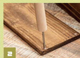
2 側板のビスをとめる位置にキリで下穴をあけ、側板2枚と天板をビスでとめてコの字型を作ります。
