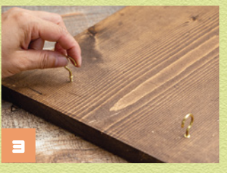
3 洋灯を手で回しながら固定します。手が痛くなってしまう場合はペンチで挟んで回しましょう。
