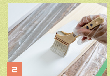
2 材料を塗装します。材料にささくれなどがある場合は240番程度の紙やすりで研磨してください。下を汚さないようにビニールなどを敷いておきましょう。
