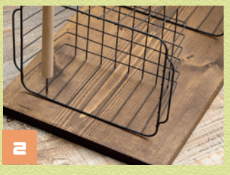
2 カゴを置いて洋灯吊金具の位置を決めます。そしてキリで下穴をあけます。
