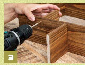
3 中板と仕切り板をずらした位置にビスで固定します。
